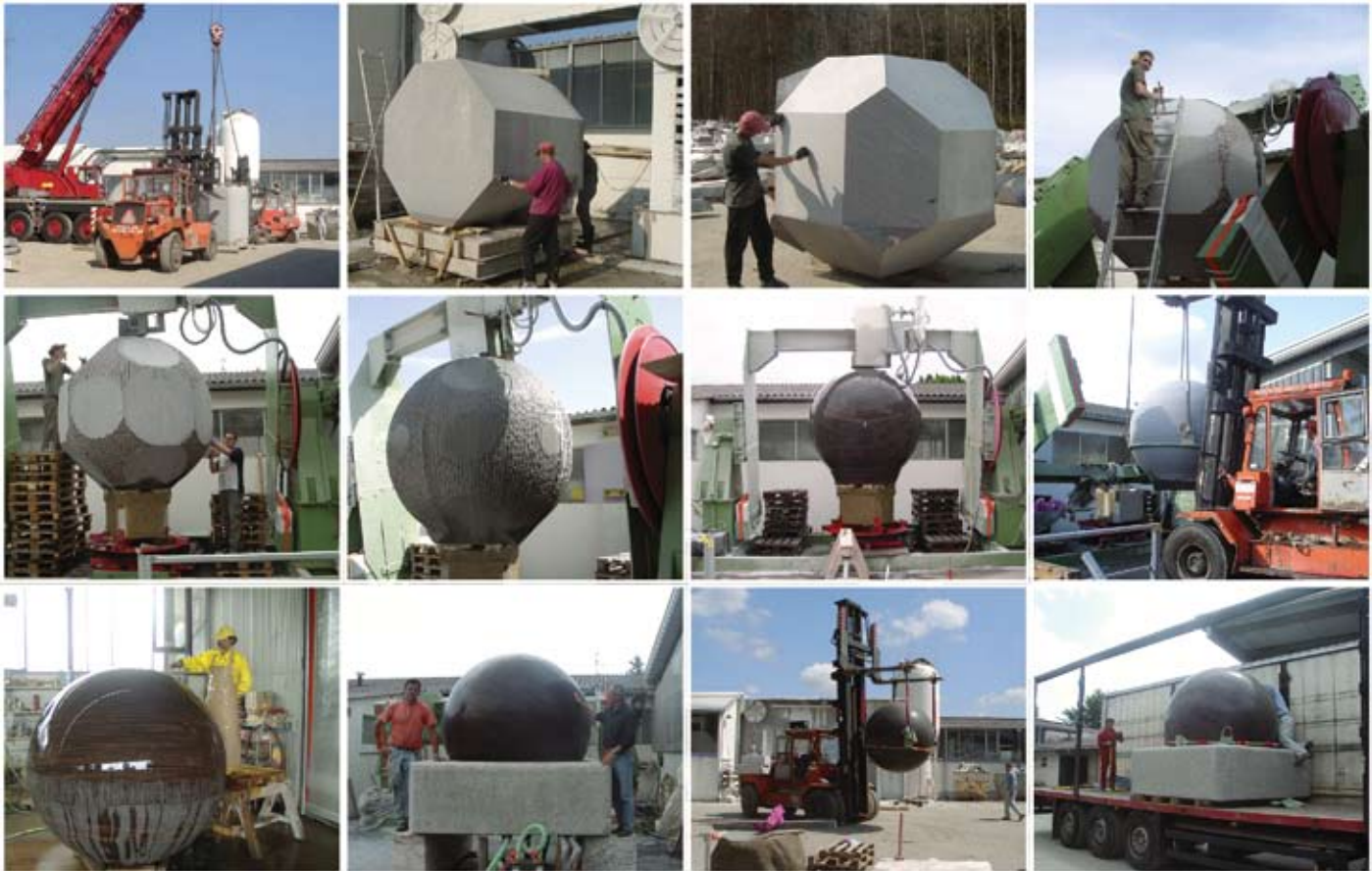
Этапы производственного процесса изготовления плавающего шара диаметром 2 м из монолитного куска гранита весом около 40 т.
